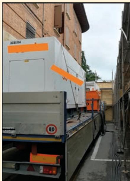
Foto 4. Gruppo elettrogeno noleggiato per la produzione di calore necessario a riscaldare l'intero edificio infestato.
