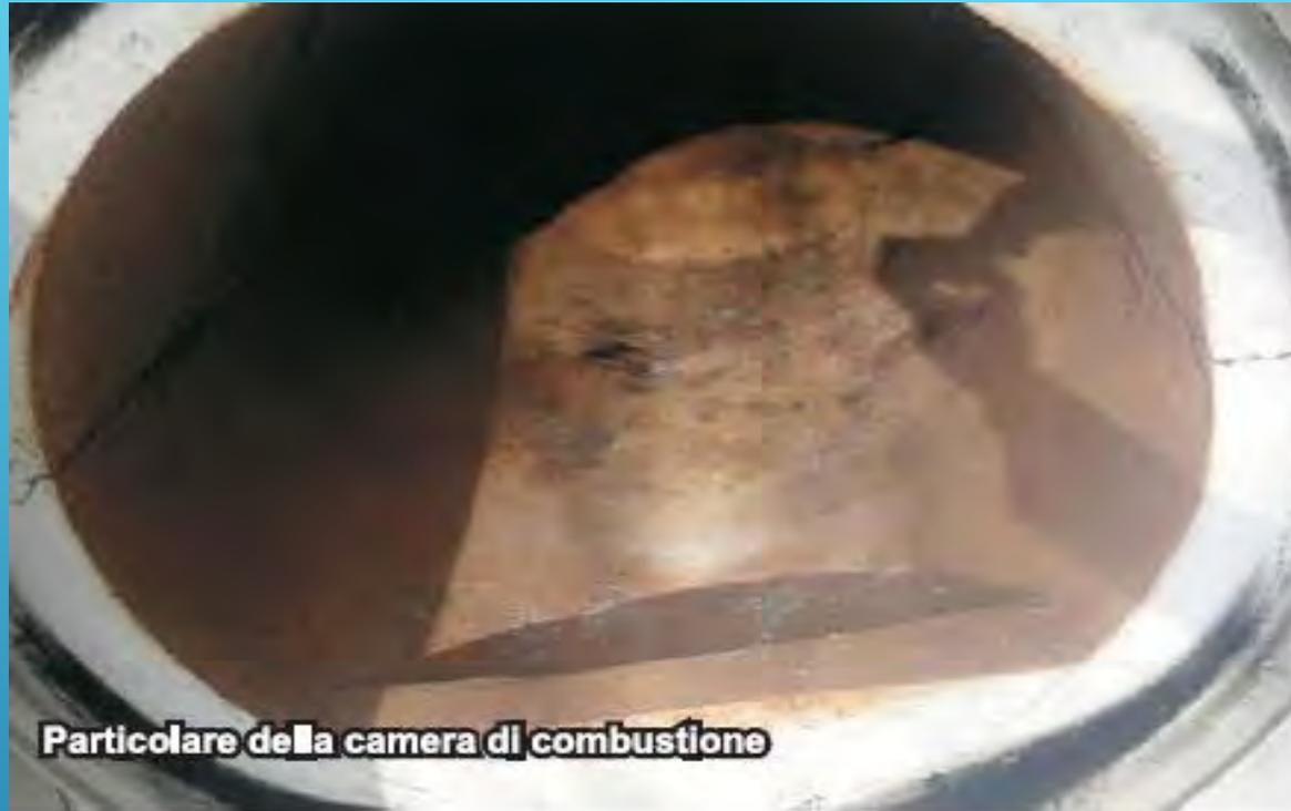
**Particolare della camera di combustione**
