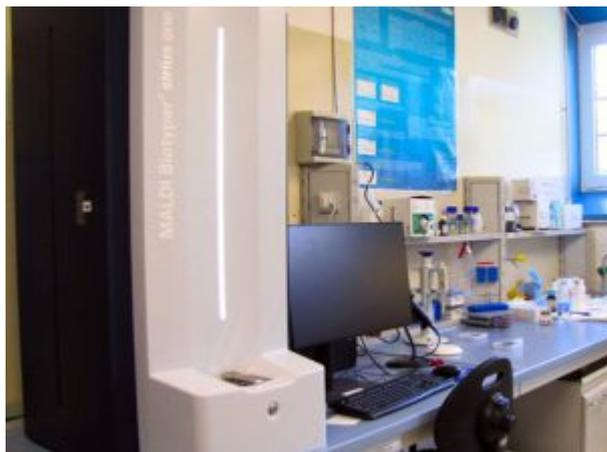
Dal 28 marzo i laboratori dell'Istituto zooprofilattico sperimentale della Sardegna hanno a disposizione un nuovo strumento diagnostico, il MALDI-TOF, acronimo di "Matrix-Assisted Laser Desorption/Ionization – Time of Flight", uno spettrometro di massa che consentirà una significativa riduzione dei tempi di diagnosi. Il modello adottato, il *sirius one*, è la versione del MALDI-TOF più avanzata tra quelle in uso negli Istituti zooprofilattici sperimentali di tutta Italia.
